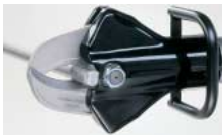
Ausnutzen der höchsten Schneidkraft Cutting with maximum force at center of motion
